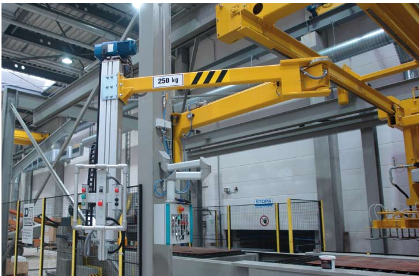
Vollautomatisch wird das Blechbearbeitungszentrum aus dem Lagersystem (im Foto hinten) mit Material versorgt
